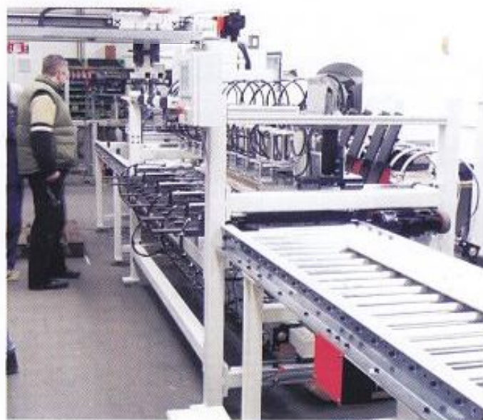
Montaż robota do przybijania listew w wągrowieckiej fabryce trumien.
